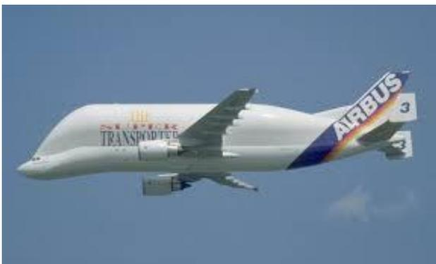
Airbus est un véritable meccano géant de la construction aéronautique française. Dans plusieurs pays membres de l'UE, on fabrique des éléments de l'avion qui seront ensuite transportés par des avions cargo spéciaux vers les chaînes d'assemblage des sites d'assemblage.
